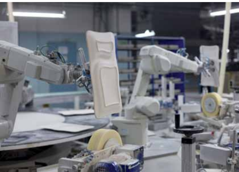
Na zdjęciach od lewej: roboty pracujące przy prasach izostatycznych; piec do wypału ostrego Riedhammer.
